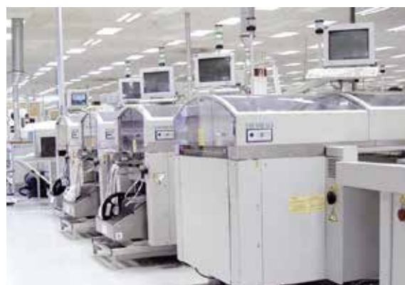
Parque de máquinas para a colocação de componentes eletrónicos
