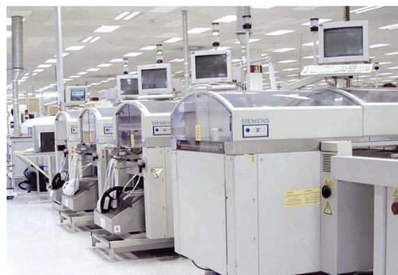
Parque de máquinas para a colocação de componentes electrónicos
